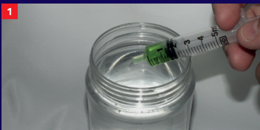
Dem Wasser wird Schaummittel Klasse A mit der vom Hersteller empfohlenen Zumischrate beigegeben.
