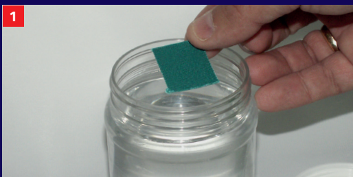
Ein Stück trockener Stoff wird auf die Oberfläche von reinem Wasser gelegt.
