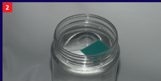
Das reine Wasser durchfeuchtet den Stoff nicht, die Oberseite des Stoffs bleibt trocken.
